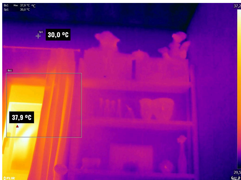
Cristal de ventana de mala calidad (carpintería de aluminio y vidrio simple sin rotura de puente térmico): 37,9 °C. Cajón de persiana: 30 °C.
